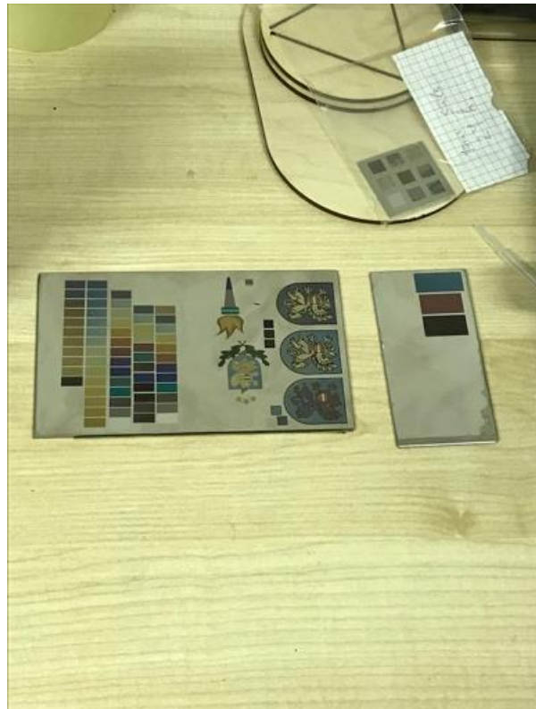
Mittels Lasertechnologie verschiedene Farben auf einer Oberfläche erzeugen
