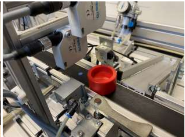
Teil der Fertigungsstrecke (Lagenkontrolle)
