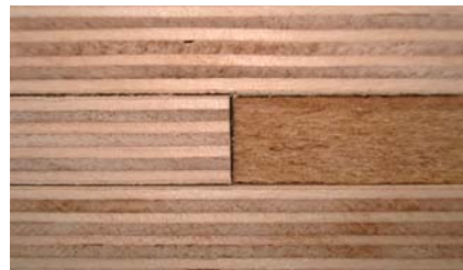
Seitenwand mit eingeleimtem Weichfasermaterial
