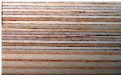
Seitenwand aus Multiplexleisten
