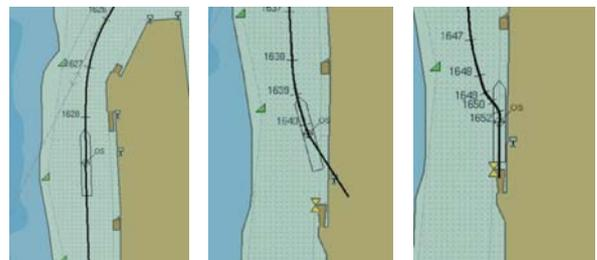
Simulierter Verlauf eines automatischen Anlegemanövers des Fährschiffes „Mecklenburg-Vorpommern“, das mit dem original ADANAV-Regler der Universität Rostock nach den Planungsvorgaben einer kinematischen Folge durchgeführt wurde. (Bilder: Universität Rostock)
