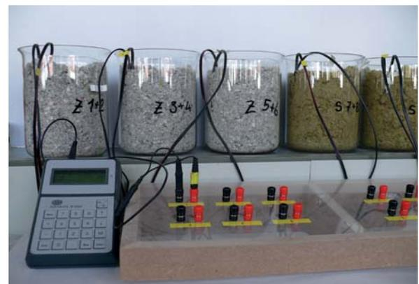
Ermittlung des Wasseraufnahme- und Trocknungsverhaltens unterschiedlicher Dämmmaterialien
