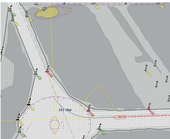
In eine ECDIS integriertes Planungsmodul zur Erzeugung kinematischer Wegpunkte. (Rot: Geplante Wegpunktfolge, Blau: Optionale Erweiterung der Wegpunktfolge in Abhängigkeit der Vorgaben, Gelb: Hilfslinien) (Bild: Planungsmodul IMaReS)
