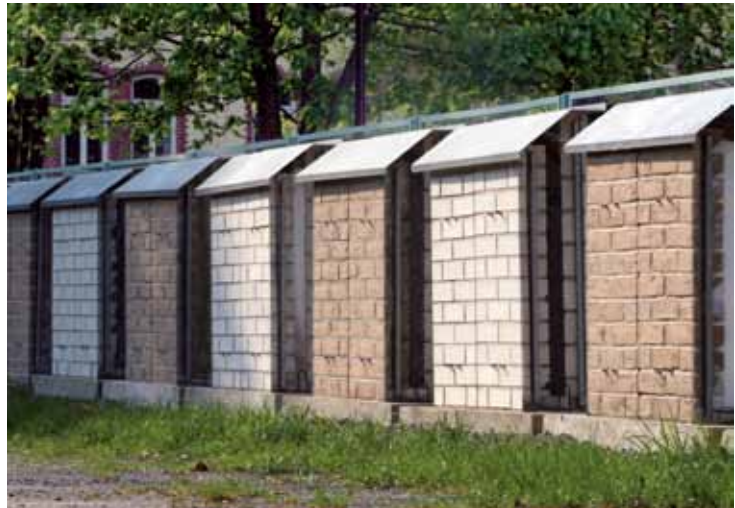
Verschiedene Dämmmaterialien wurden in einem Feldversuch auf ihre Eigenschaften untersucht
