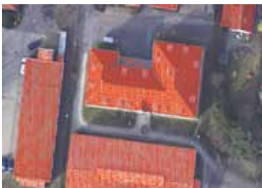
Laserscan: Klassifizierte Dachpunkte, dem RGB-Bild überlagert
