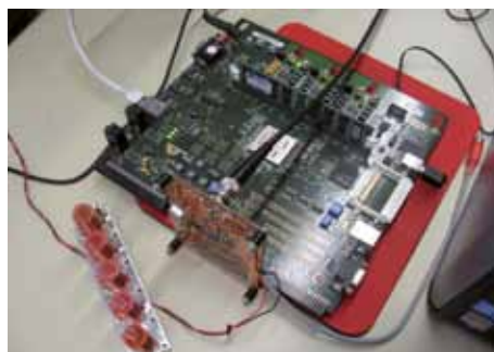
Hardware des AIS-Boards und Testumgebung
