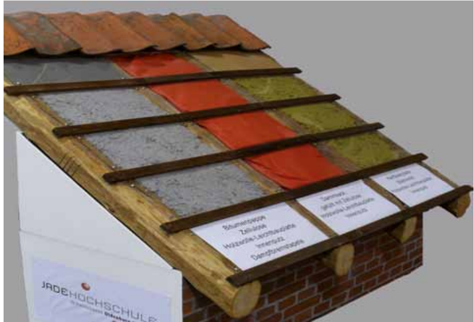
Im Rahmen des Projekts wurde ein Dachmodell erstellt, in dem drei unterschiedliche Dachaufbauten mit Einblasdämmung dargestellt sind. Hier können die Möglichkeiten und Problempunkte verschiedener Verfahren anschaulich erklärt werden
