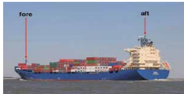
Abb. 1: Anordnung der beiden GPS-Antennen auf einem Containerschiff. Durch die große Separation in Längsrichtung ergibt sich eine extrem hohe Winkelauflösung.
