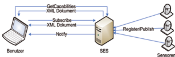
Darstellung der Anfragemöglichkeiten und Antworten bzw. Benachrichtigungen eines Sensor Event Service
