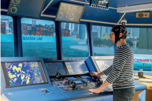
Im Fraunhofer-Transferzentrum erforschen Wissenschaftler neue Verfahren der Neuroergonomie, um die mentale Anstrengung am Arbeitsplatz und bei der Nutzung von Technologien zu messen. Im Bild der Einsatz von mobilen Elektroenzephalografie-Messgeräten (EEG) in dem Schiffsbrücken Simulator am Studienort Elsfleth.
