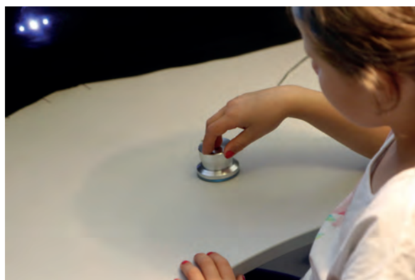
Während der Messung hat das Kind die Aufgabe, ein Geräusch zu orten und einen LED-Leuchtpunkt mit einem Drehregler in eine der 37 möglichen Schallrichtungen zu drehen.
