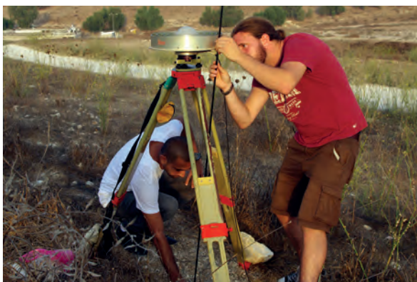
Studierende aus Oldenburg und Haifa bauen eine GPS-Antenne über einem Messpunkt auf.
