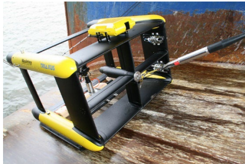
Industrielle Trägerplattform TRIAXUS. Die installierte Messtechnik wird zur Inspektion von Unterwasserpipelines oder zum Einsatz in der Meeresforschung verwendet. Das System wird hinter dem Schiff geschleppt und kann entlang des Transektes missionspezifisch verschiedene Positionen in der Wassersäule aufsuchen. (Bild: Jan Schulz; TRIAXUS an Bord des bundesdeutschen Fischerei-Forschungsschiffes Walther Herwig).
