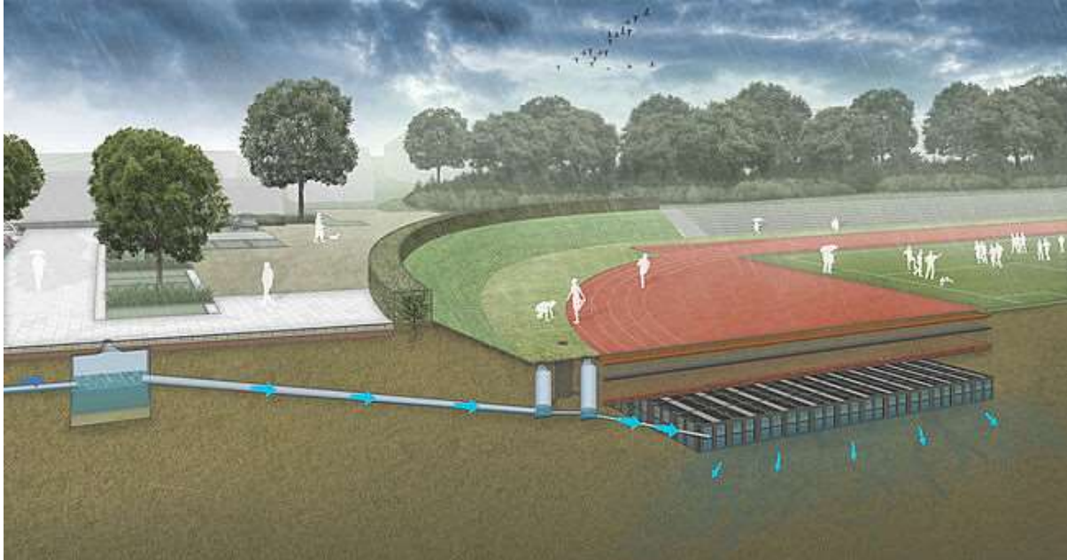
Prinzipiskizze Sportplatz zur Regenwasserspeicherung [4]
