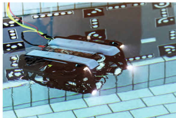
Die Unterwasserfahrzeuge sind mit einem photogrammetrischen Kamerasystem zur dreidimensionalen Erfassung von Objekten unter Wasser ausgestattet
