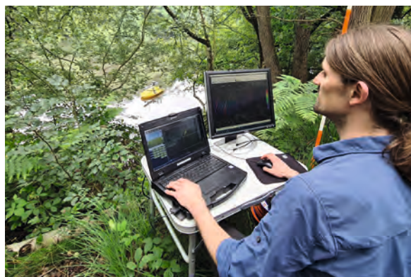
Die Geodäsie-Studierenden lernten unter anderem die Sensorik eines autonom fahrenden Wasserfahrzeugs kennen. Es erfasst mittels Echolot linienförmige Tiefeninformationen der Le-the-Talsperre
