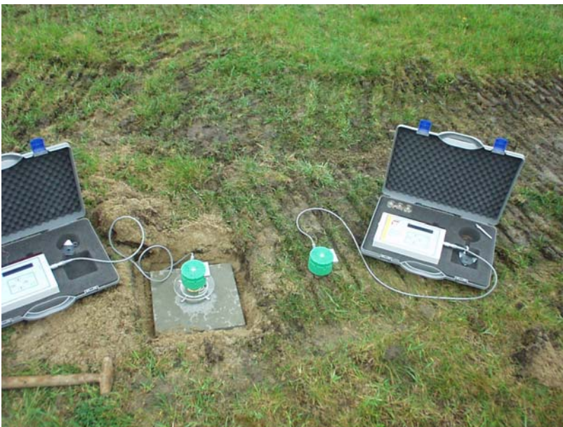
Bild 4: Messgeber auf einer Gehwegplatte und auf einem Erdspieß
