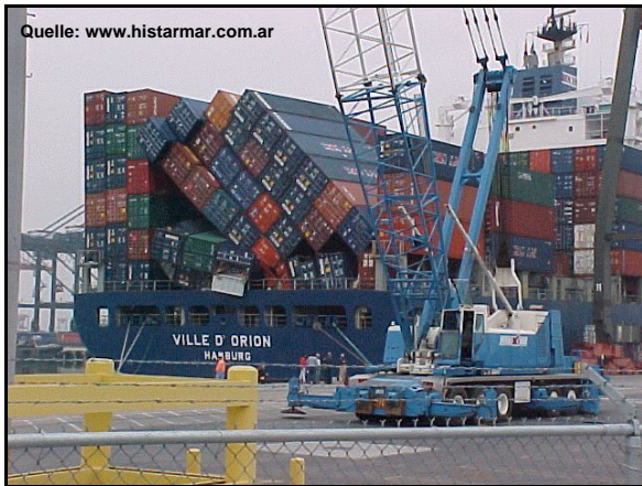
Ladungsverschiebung durch Rollbewegungen
