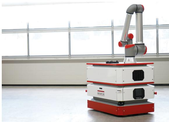
Abbildung 1: Fahrerloses Transportsystem mit Leichtbauroboter
