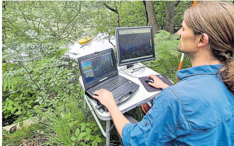
Mobile Office statt Home-Office: Die Geodäsie-Studierenden lernten unter anderem die Sensorik eines autonom fahrenden Wasserfahrzeugs kennen. Es erfasst mittels Echolot linienförmige Tiefeninformationen der Lethe-Talsperre. BILD: LENA WIEGAND, JADE HS
