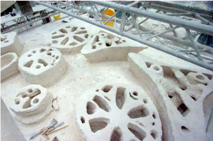
**Abb. 6: Mit D-Shape Methode gedruckte Säulen**
