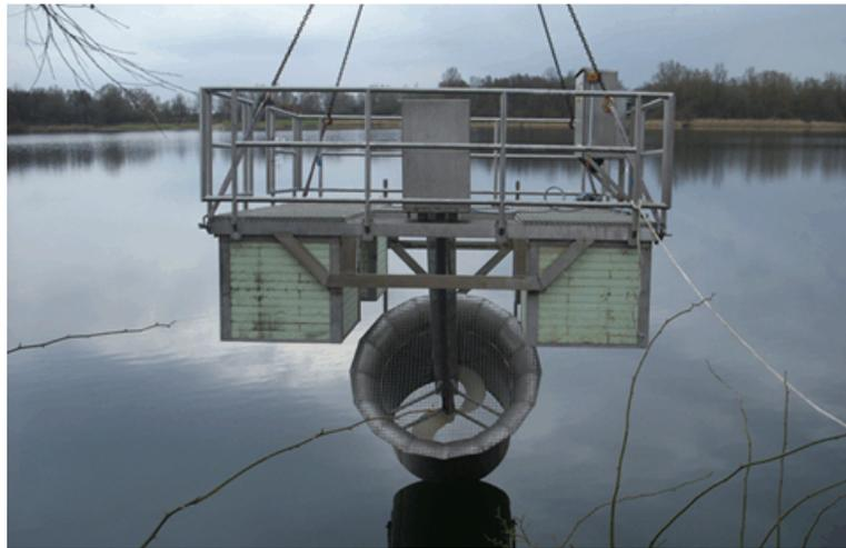
Bild 1 Freistrahlanlage BANT 1 mit den Hauptelementen zylindrisches Leitrohr und Propeller sowie mit den Schwimmkörpern, Banter See Wilhelmshaven /5/
