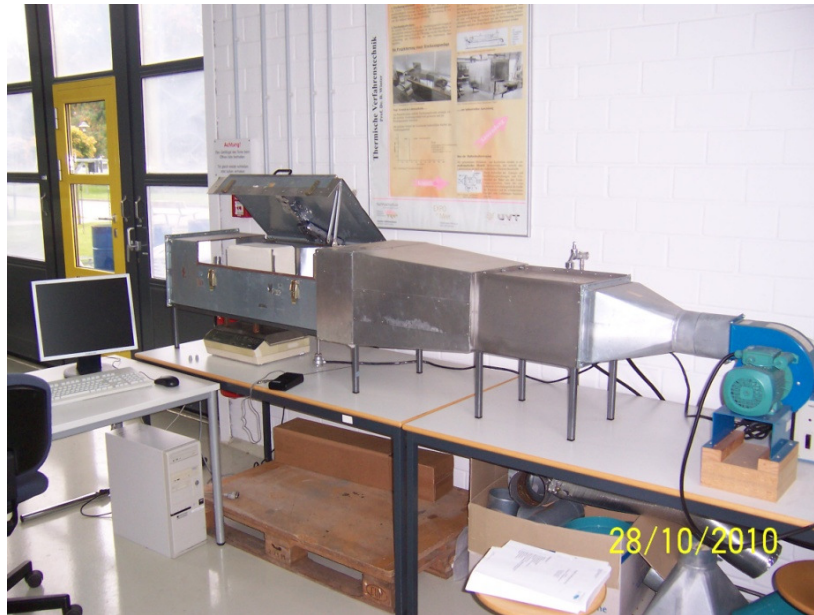
Bild 2 Laborkonvektionstrockner, Institut Energie- Verfahrens- und Umwelttechnik (EVU), Studienort Wilhelmshaven
