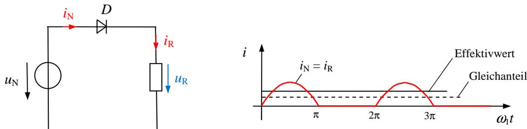
Der Effektivwert von der sinusförmigen Netzspannung ist bekannt. Der Stromeffektivwert ist gleich dem Effektivwert der Ausgangsspannung  $U_R$  dividiert durch den Widerstand  $R$ .
