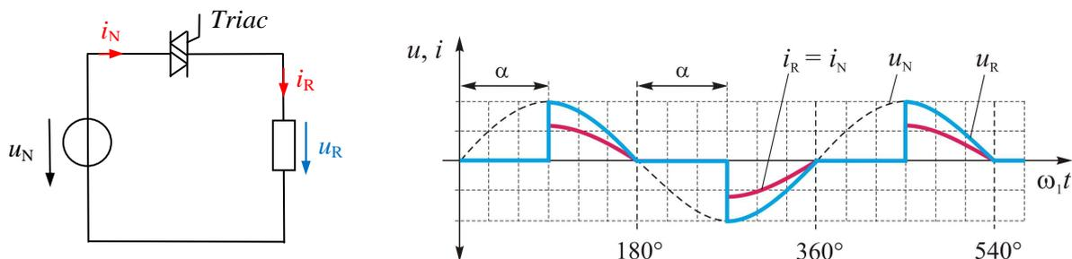
Der Steuerwinkel beträgt  $\alpha = 90^\circ$ . Berechnen Sie mit Hilfe der Fourier-Analyse die unten aufgeführten elektrischen Größen in allgemeiner Form, d.h. in Abhängigkeit von den Variablen  $\hat{u}_N$  ( $\hat{u}_N = \hat{u}_R$ ) sowie  $R$ . Die Verluste des Stellers sind dabei zu vernachlässigen.
