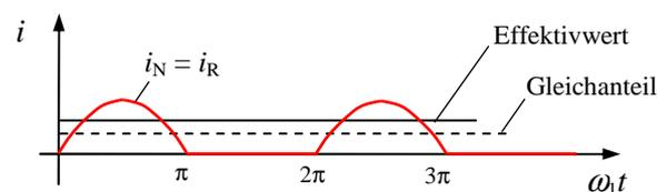
Die Komponenten des Verbraucherstromes wurden in Kap. 1.3.2 schon berechnet. Dieser Strom im Widerstand fließt auch auf der Netzseite.
