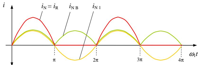
Zwischen den Grenzen  $\omega_1 t = 0$  und  $\omega_1 t = \pi$  gilt für den Ausgangsstrom  $i_N$  die Formel:
