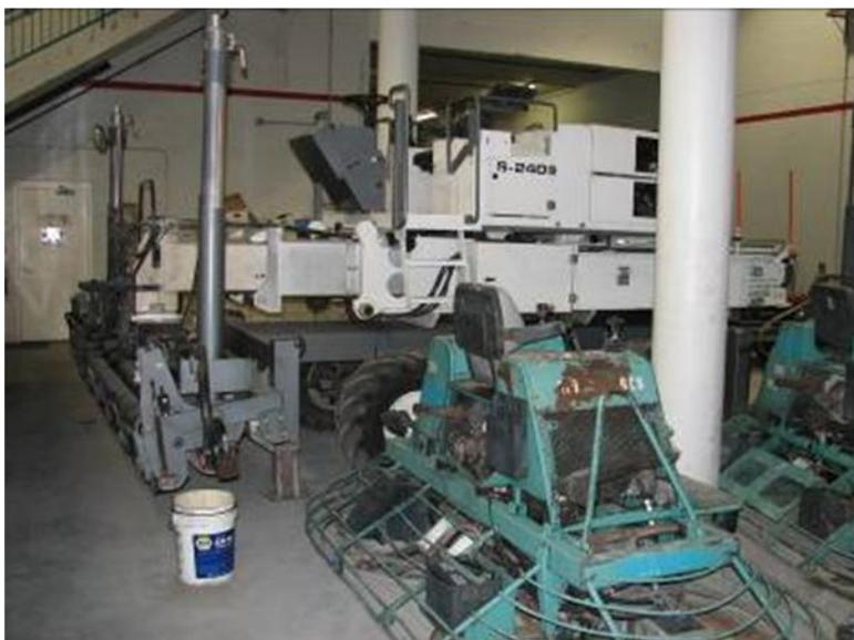
Anschließend wird der Beton glatt geschliffen. Die Schleifer fahren über den Beton und entfernen jede noch so kleine Unebenheit, es entsteht eine komplett ebene Fläche.
