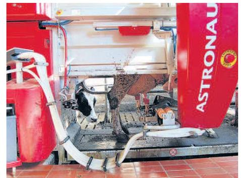
Laserlicht tastet das Kuheuter ab, bevor die Maschine mit dem Melken beginnt.
