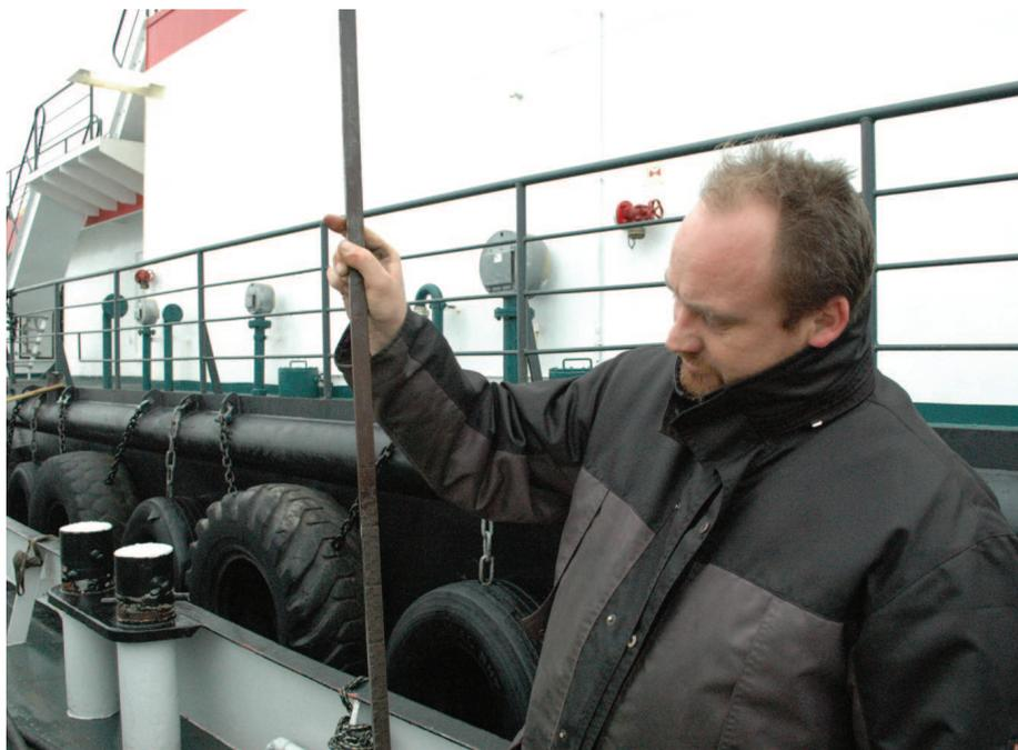
Bei Schiffen stoppt der Tankvorgang nicht wie beim Auto automatisch. Es muss ähnlich wie beim Ölmesen mit einem Peilstab geprüft werden, wieviel Platz noch im Tank ist.
