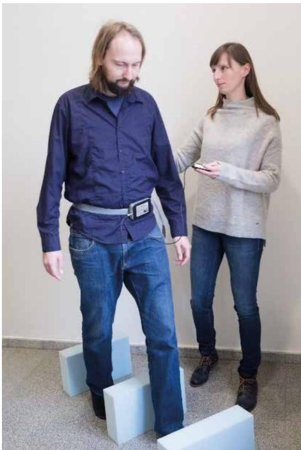
Alina Baltus und Annäus Wiltfang während einer Probestimmung des Gleichgewichts mit Hilfe des Vertiguard-Systems (Sensorgürtel, der Längs- und Querbewegungen dokumentiert und analysiert).
