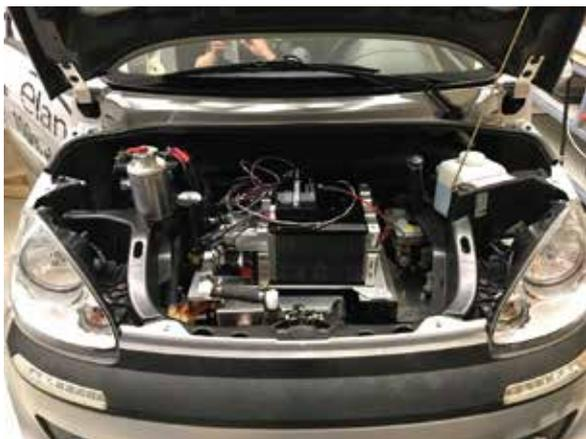
Integration des Brennstoffzellen-Systems im Fahrzeug.
