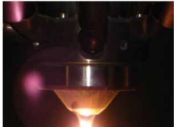
Nahaufnahme des Laserpulverauftragschweißens
