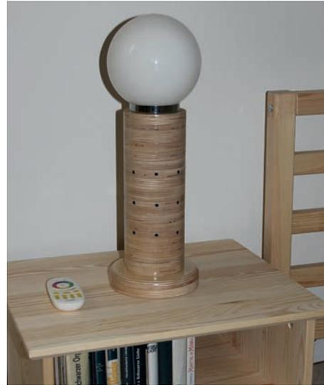
Lampe mit einer integrierten mehrkanaligen Mikrofonanordnung. Diese Lampe soll später nur auf Sprachanweisungen des Nutzers reagieren, wenn dieser seinen Kopf in ihre Richtung orientiert.
