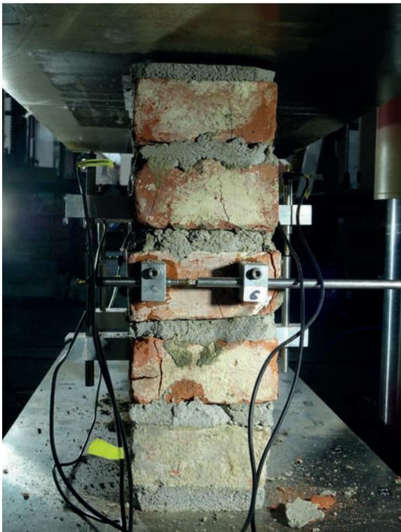
Versuchsaufbau: Druckfestigkeitsbestimmung von Mauerwerk
