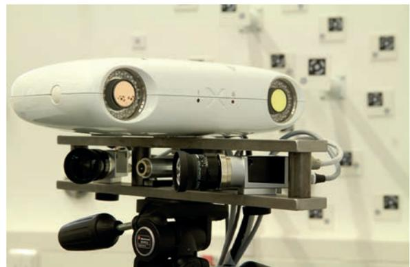
Abb. 1: Aktueller Messkopf: oberes Stereokamerasystem (AXIOS 3D Services GmbH) dient der Navigation, unteres Stereokamerasystem (Basler AG) sowie Linienlasermodul dient der Oberflächenerfassung
