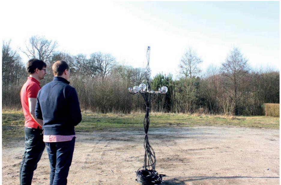
Zusammenarbeit in Lehre und Forschung: Versuchsaufbau von Mitarbeitern der Jade Hochschule und des Fraunhofer IDMT mit einem System zur akustischen Detektion von zivilen Quadkoptern. Bild: Fraunhofer IDMT
