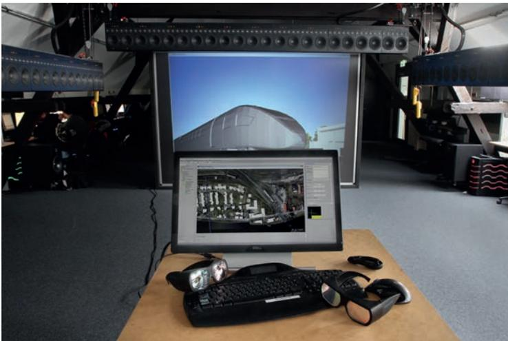
Ausführung der Anwendung im Labor für virtuelle Welten. Steuerungsfenster auf dem Monitor, stereoskopische Darstellung der Animation auf der Leinwand
