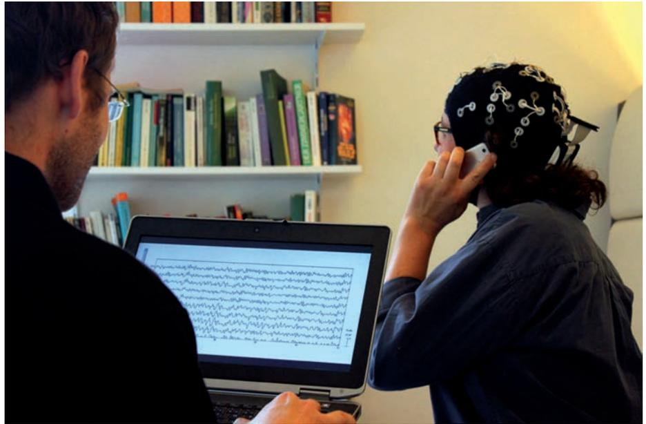
Im Fraunhofer-Transferzentrum erforschen Wissenschaftler\_innen neue Verfahren der Neuroergonomie, um die mentale Anstrengung bei der Nutzung von Technologien zu messen. Im Bild der Einsatz von mobilen Elektroenzephalografie-Messgeräten (EEG). Bild: Fraunhofer IDMT
