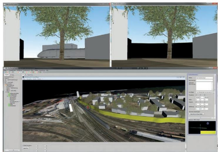
Oben links: Animation ohne Lärmschutzwand; oben rechts: Animation mit Lärmschutzwand. Unten: Steuerungsfenster der Anwendung
