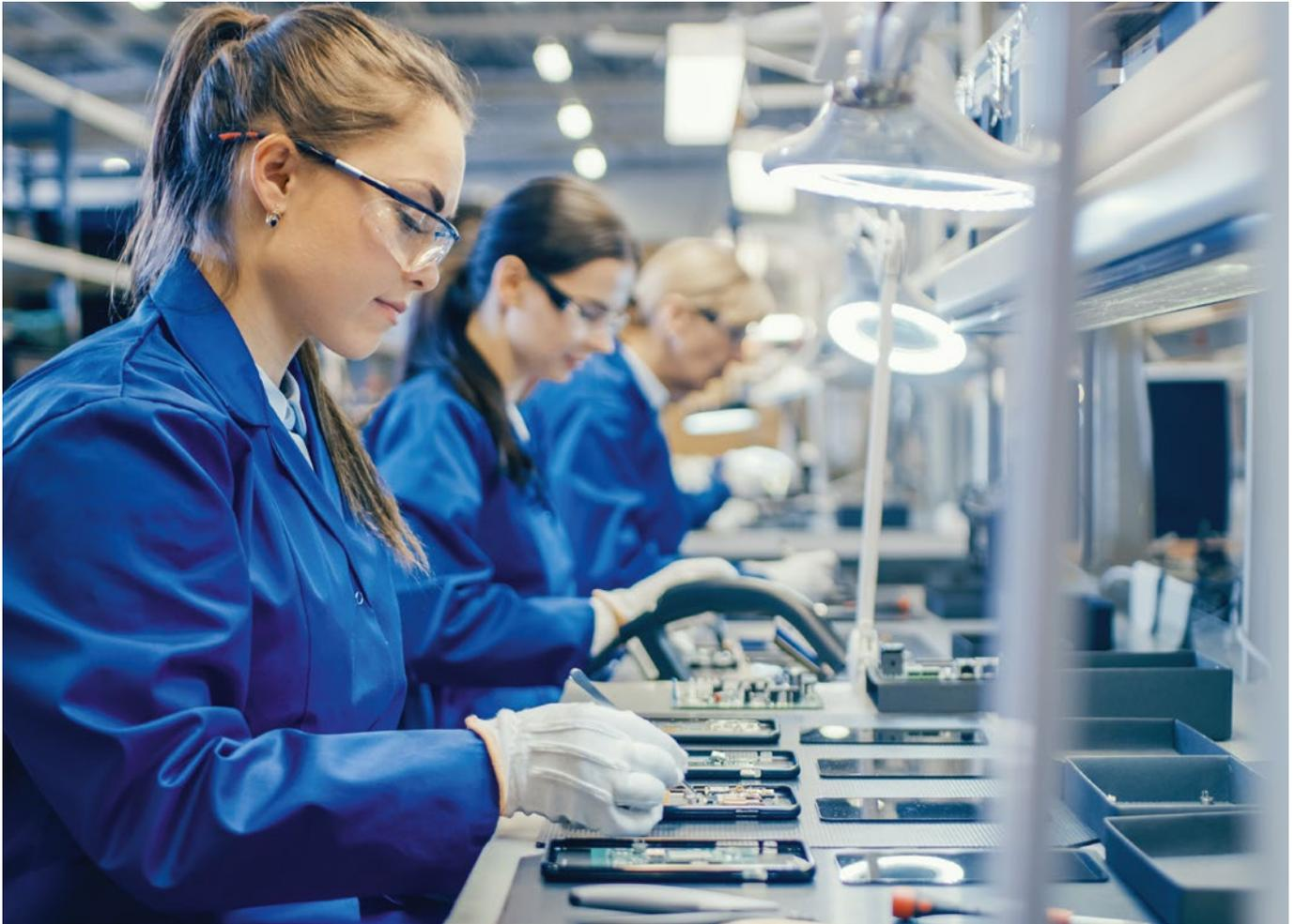
Auch bei Hightech-Produkten ist nicht überall eine getaktete, vollautomatisierte Fließfertigung möglich. Smartphones werden teilmanuell gefertigt – mit stark schwankenden Bedienzeiten. Um derartige Prozesse zu analysieren, reicht es nicht aus, einzelne Prozessschritte isoliert zu betrachten. Erst Simulationsmodelle der Fertigung ermöglichen die Abbildung von Netzwerkeffekten.
