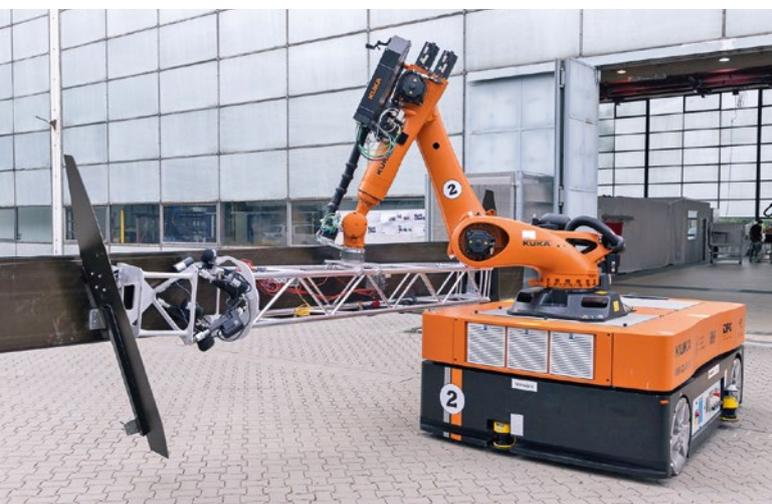
Ressourcen und Zeit sparen: Ein mobiler Roboter transportiert eine Landeklappe, die von einem leichten Aluminiumgerüst stabilisiert wird.
