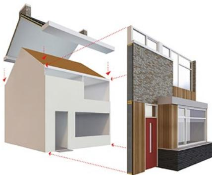
In einer intelligenten Fabrik werden passgenau Fassaden- und Dachpaneele inklusive Solar-, Heizungs- und Ventilationssystemen für die Montage am bestehenden Haus automatisiert gefertigt.
