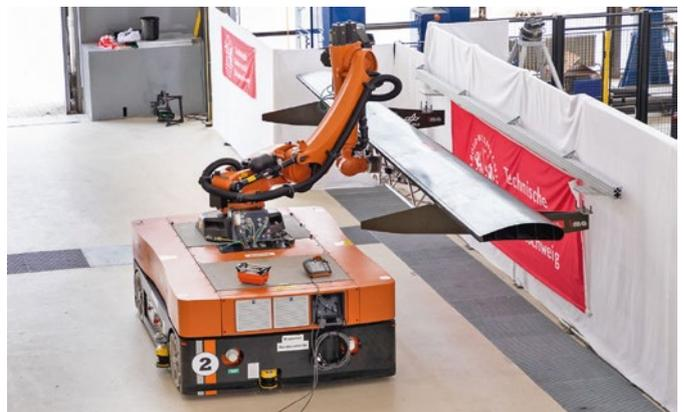
Der mobile Roboter fährt das Landeklappen-Modul zur Montagelinie und richtet es mit Aktoren präzise aus.
