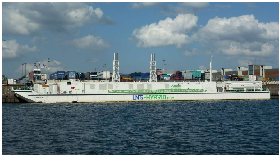
76 Meter lange LNG-Barge „Hummel“ mit zwei Flüssiggas-Tanks am Heck
