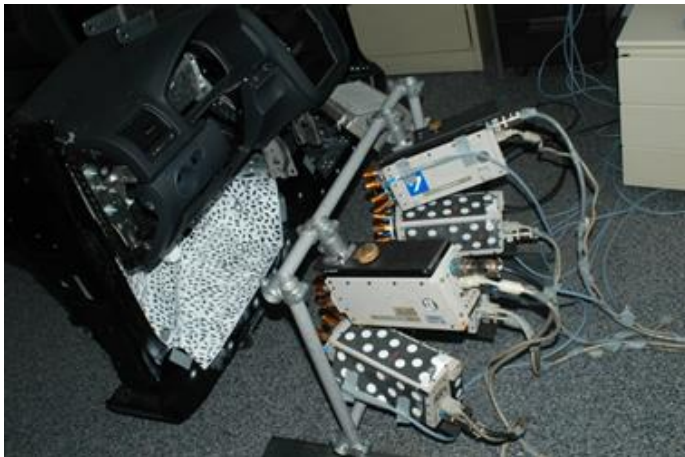
4 Highspeedkameras zur Erfassung des Fußraumes
