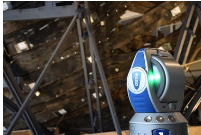
Netzmessung mit Lasertracker: RMS = 0,05mm
