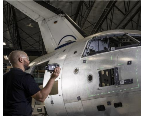
Online Bilderfassung mit Sichtfeldprojektion
