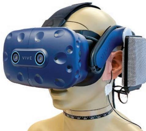
Ein kommerzieller Kunstkopf „KEMAR“ trägt die VR-Brille mit extraauralen Kopfhörern. Diese wurden mit einer speziell angefertigten 3D-gedruckten Halterung befestigt.
