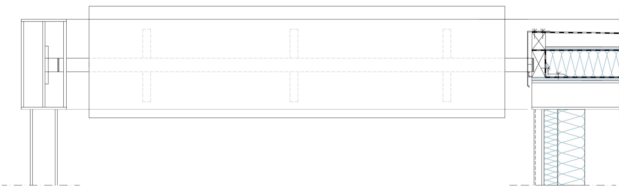
Dach Lamellen Detail, geöffnet
