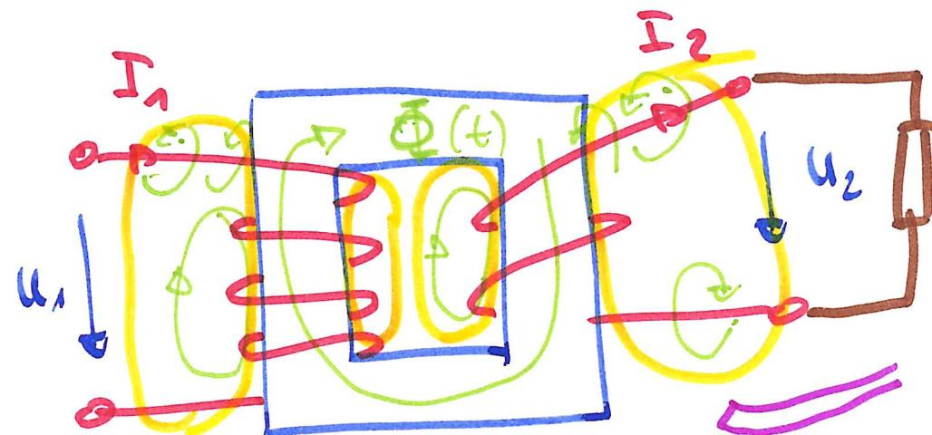
leakage flux  $\Phi_L$
